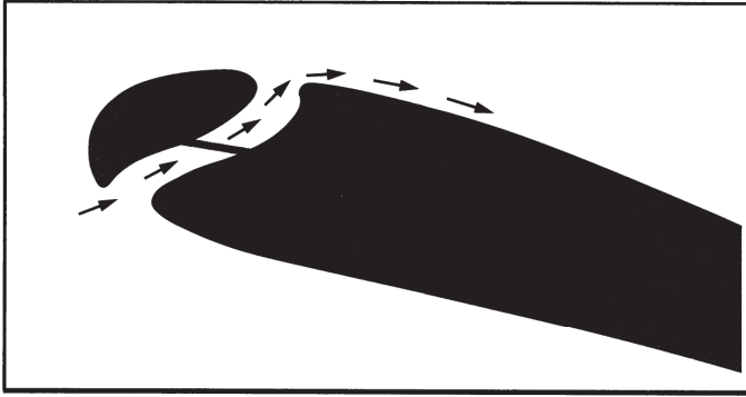
Figure IV-30 : apport d'énergie cinétique au tube de courant longeant l'extrados
