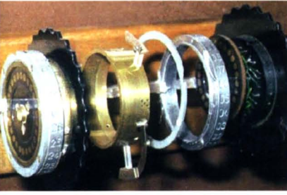
Un rotor d'Enigma, entier à gauche et démonté à droite. Les fils réalisant les connexions sont visibles.
